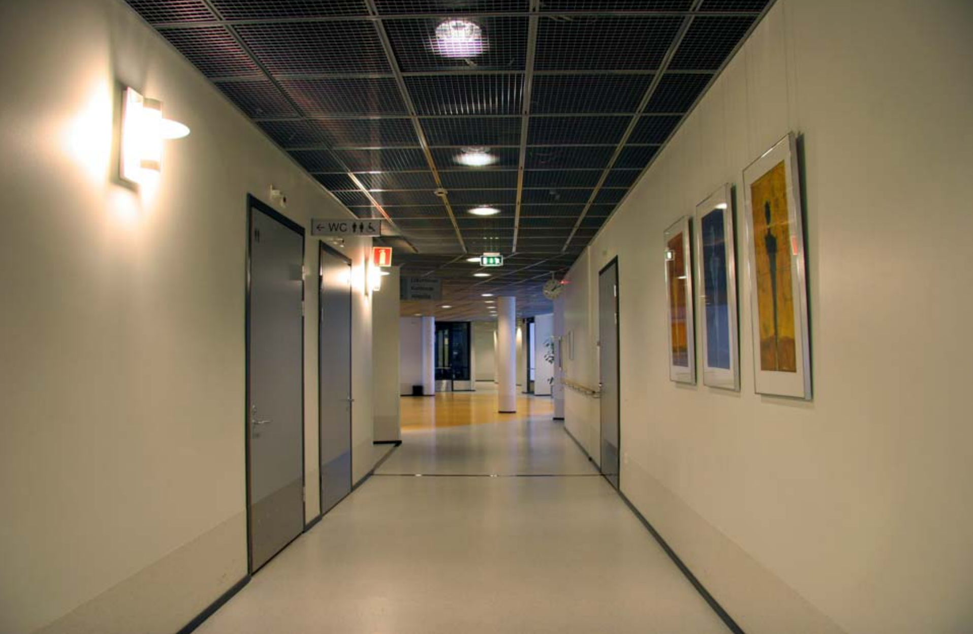
14. Tiloissa on helppo liikkua, vaikka näkö olisi heikko, kun ovet erottuvat seinistä tummuudeltaan ja myös jalkalistassa on kontrasti. Katon ja seinän tummuusero auttaa tilan hahmottamisessa. (Synapsia)
