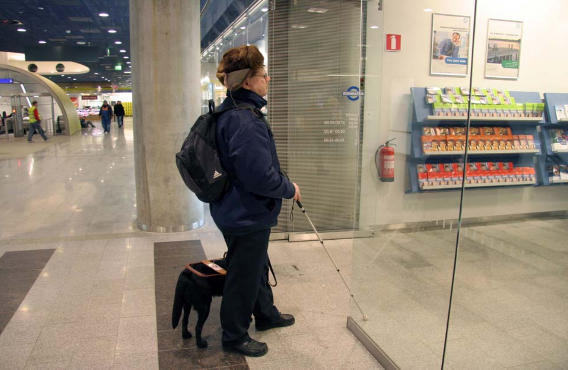
5. Lasiseinät ovat vaikeita havaita. Opasteita ei pitäisi koskaan kiinnittää lasipinnalle. (Kampin keskus)
