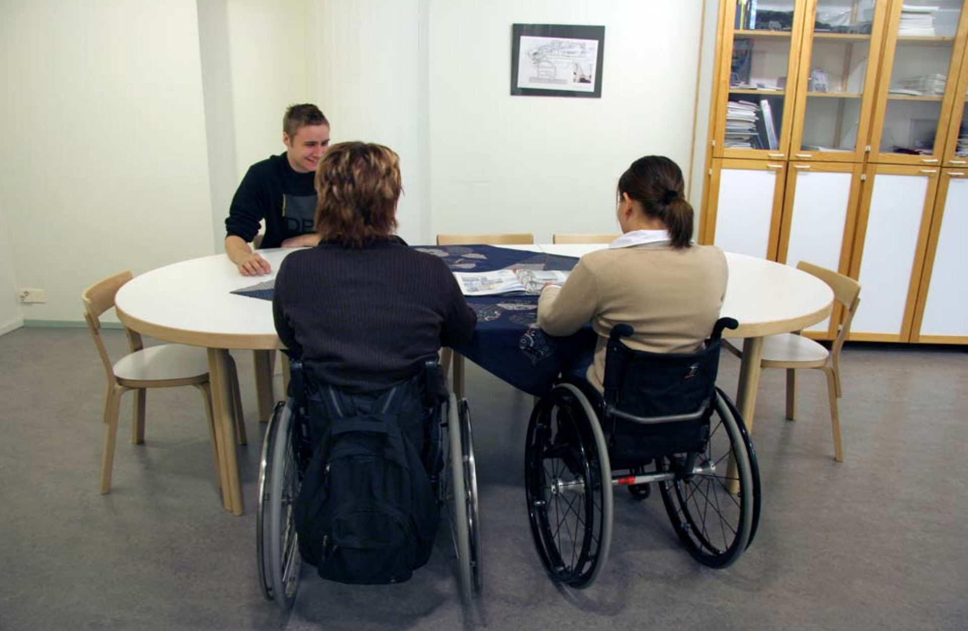
13. Kokouspöydässä tarvitaan pyörätuolille tilaa leveysuunnassa 900 mm. Sopiva pöydän korkeus on 750-800 mm. (Kumpulantie 1)
