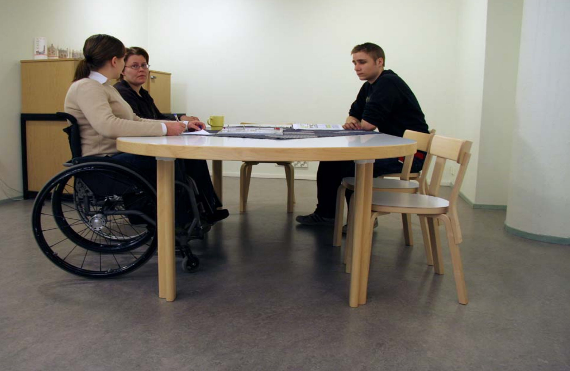
12. Pyörätuolissa istuva henkilö tarvitsee pöydän alla vapaan polvitilan jonka korkeus on 670 mm, leveys 800 mm ja syvyys 600 mm. (Kumpulantie 1)
