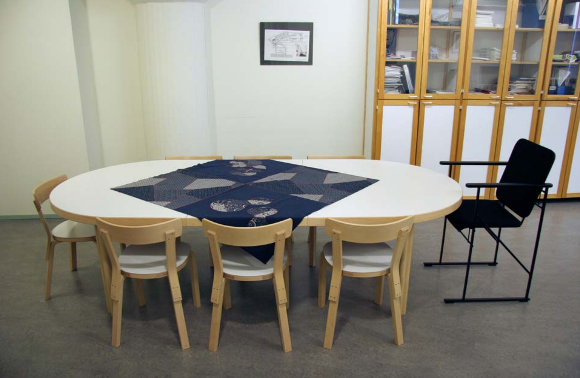
14. Kokoushuoneen pöydässä yhtä tuolia varten tarvitaan tilaa leveyssuunnassa 600 mm. Kolmen tavanomaisen tuolin tilaan mahtuu kaksi pyörätuolia. Tavanomaisten tuolien lisäksi tarvitaan myös korkeampi tuoli. (Kumpulantie 1)
