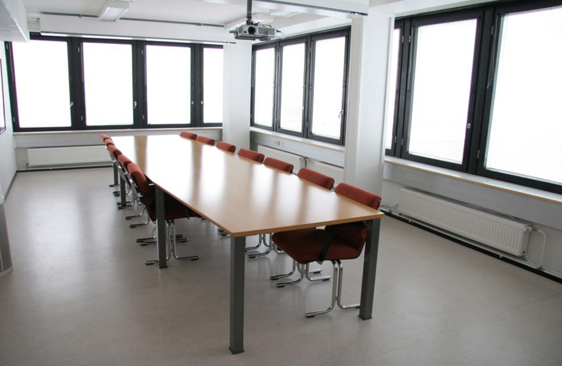
16. Jos kokoushuone on kulmassa ja ikkunat vierekkäisillä seinillä, vastavalohäikäisyä ei synny. (Kallion virastotalo)
