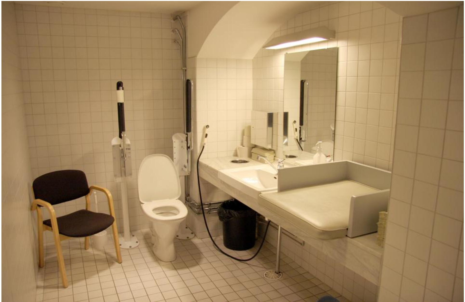
6. Esteettömässä hygieniatilassa on helppo asioida pienten lasten kanssa kun tilan lisävarusteena on vauvanhoitopöytä. Jos se on seinälle käännettävää mallia, se ei ole pyörätuolin käyttäjän tiellä. (Ateneum)
