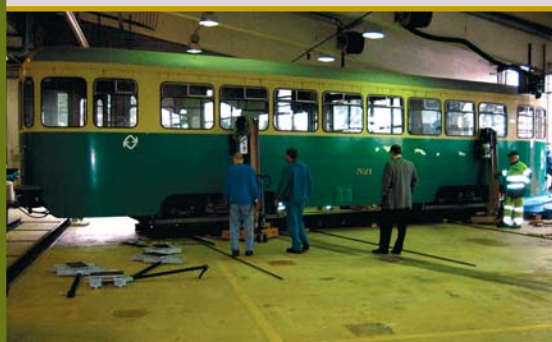
HKL:n ”loistavat” miehet, liikennepäällikkö Erkki Mutkan johdolla, vastaanottamassa paikalleen sijoitettavaa vaunua. Siirtämisessä käytetään apuna raiteen alla olevia pyöreitä terästankoja.
