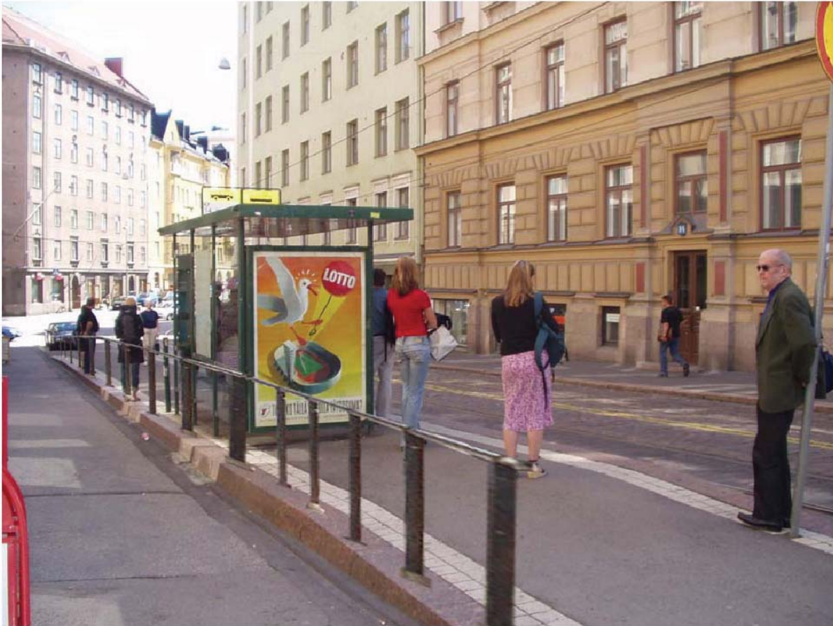
Kuva 25. Valokuvasovitukseen on lisätty kaide Fredrikinkadun korotetulle raitiotiepysäkille. Kaiteiden tarve on tullut esille alueen kävelykerroksella vammaisjärjestöjen toimesta.
