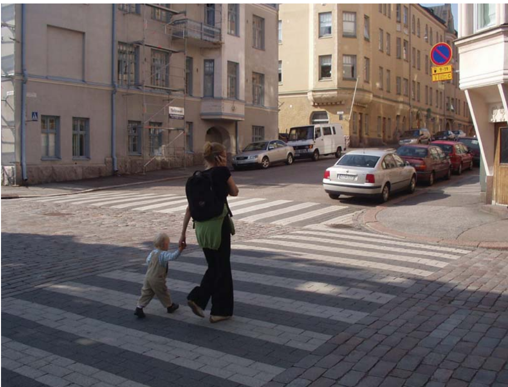
Kuva 19. Massatut ja betonikivetyt suojatiet näkyvät hyvin ja niissä on riittävä kontrasti
