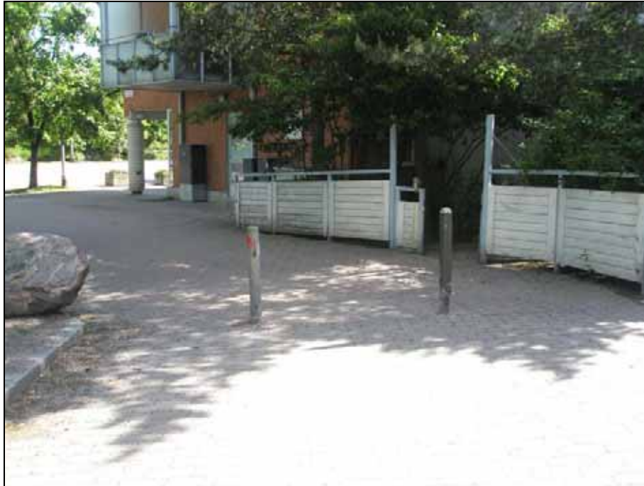
Kuva 13. Länsi-Pasilan kevyen liikenteen väylillä on useassa kohdin pollareita, jotka eivät erotu ympäristöstään ja aiheuttavat törmäämisvaaran heikkonäköiselle tai sokealle henkilölle.
