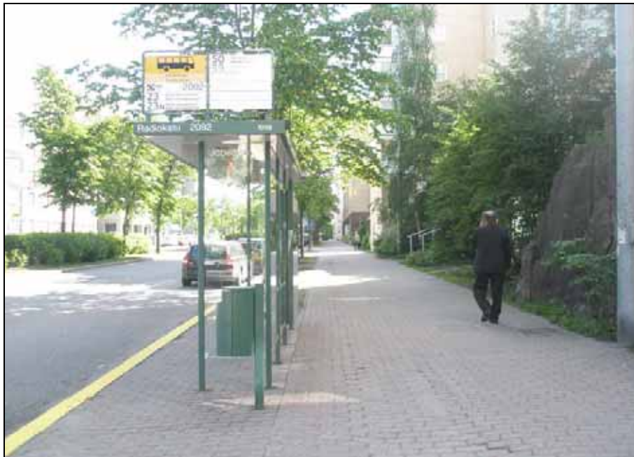
Kuva 21. Radiokadun ja Pasilankadun bussipysäkkien odotusalueet tulee korottaa Helsingin kaupungin katualueita koskevien tyyppipiirustusten 29263/9, 29263/10 ja 29263/11 mukaisesti, Länsi- ja Keski-Pasilan toimenpidekartan kohta 5.
