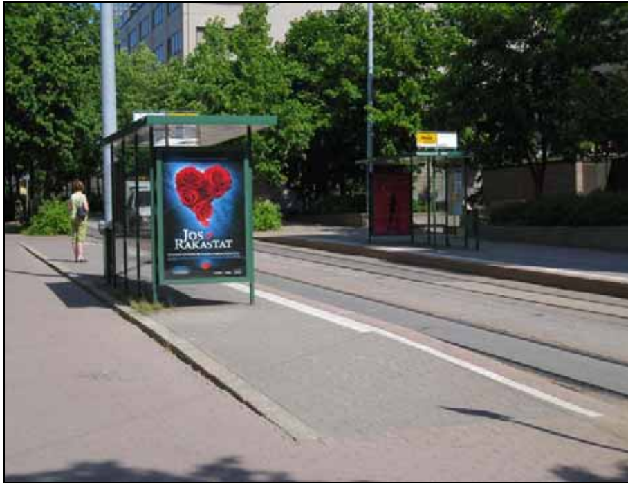
Kuva 22. Pysäkkialueen ja jalkakäytävän välisen kynnyksen kohdalle tulee asentaa alajohteellinen avokaide estämään kompastumista, Länsi- ja Keski-Pasilan toimenpidekartan kohta 6.
