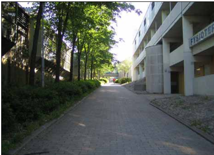
Kuva 17. Mellunmäen metroaseman viereisille, itä-länsisuuntaisille, jyrkille kevyen liikenteen väyläosuuksille tulee asentaa toiselle puolelle väylää käsijohteet kahdelle korkeudelle 700 mm ja 900 mm, toimenpidekartan kohta 3.
