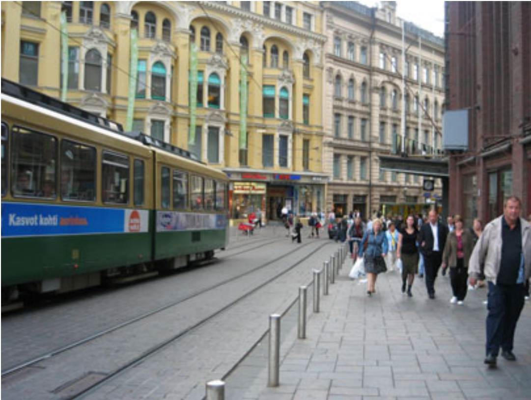
Kuva 29. Kolmensepänaukion päällysteet ovat sileitä ja aukio esteetön, mutta raitiotie aiheuttaa vaaratilanteita Stockmannin sisäänkäynnin luona. Pollaririvistä puuttuu varoitusalue.
