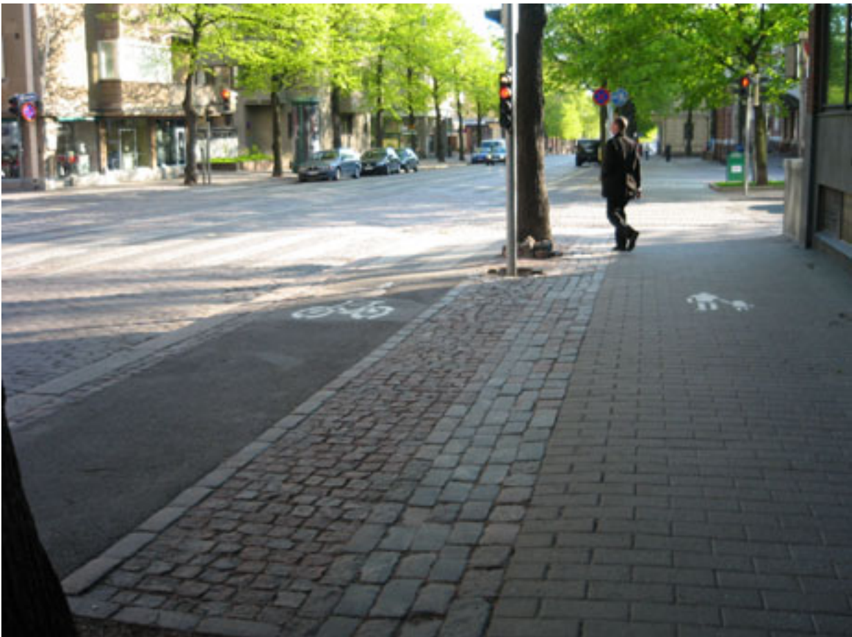
Kuva 22. Bulevardin pyörätie on selkeästi erotettu, mutta vaikeuttaa suojateiden hahmottamista.
