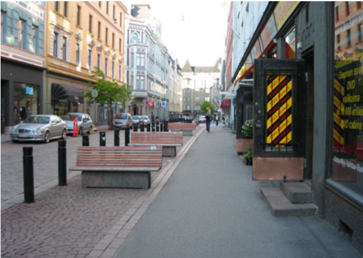
Kuva 23. Eerikinkadun kalustevyöhykkeellä on tunnistettava noppakivipäällyste. Liikkeiden sisäänkäynnit eivät ole esteettömiä ja portaat avoimine ovineen työntyvät jalkakäytävälle.
