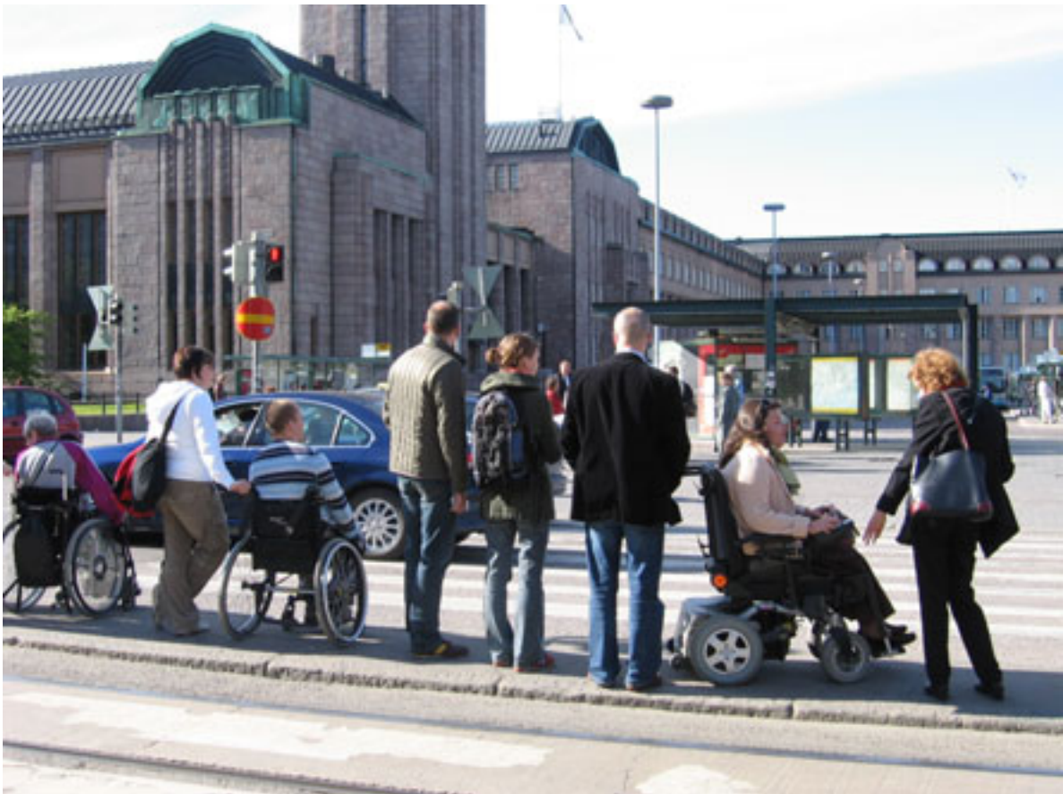
Kuva 12. Liian kapea keskikoroke pakottaa kääntämään sähköpyörätuolin tai lastenvaunut, kun Kaivokadun ylityksessä joudutaan pysähtymään keskikorokkeelle.
