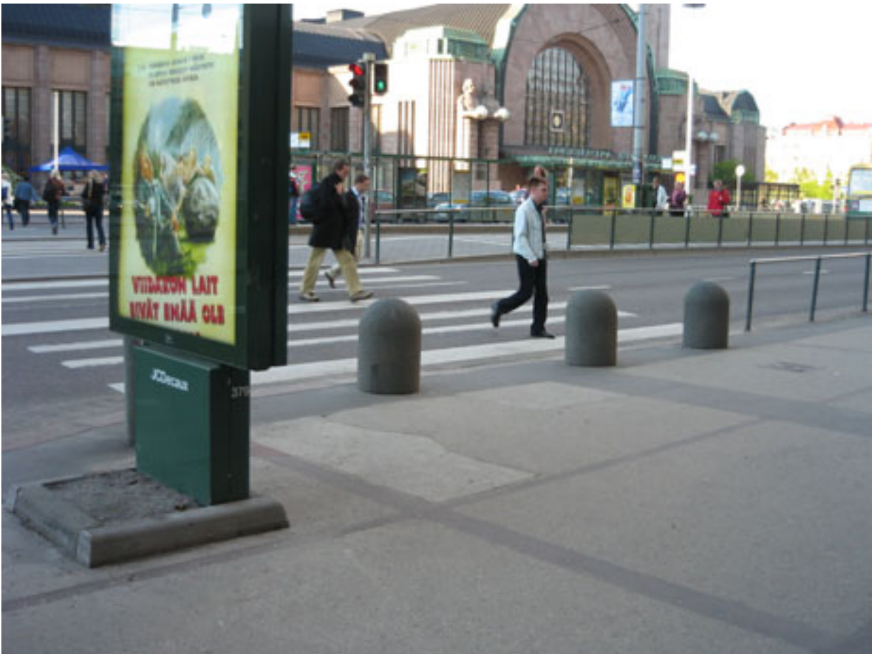
Kuva 31. Kaivokadun suojatiet ovat pääosin esteettömiä, mutta Kaivotalon pollarit ja mainoslaitteet on sijoitettu jalkakäytävälle niin, että ne ovat vaikeasti ennakoitavissa ja aiheuttavat vaaraa.
