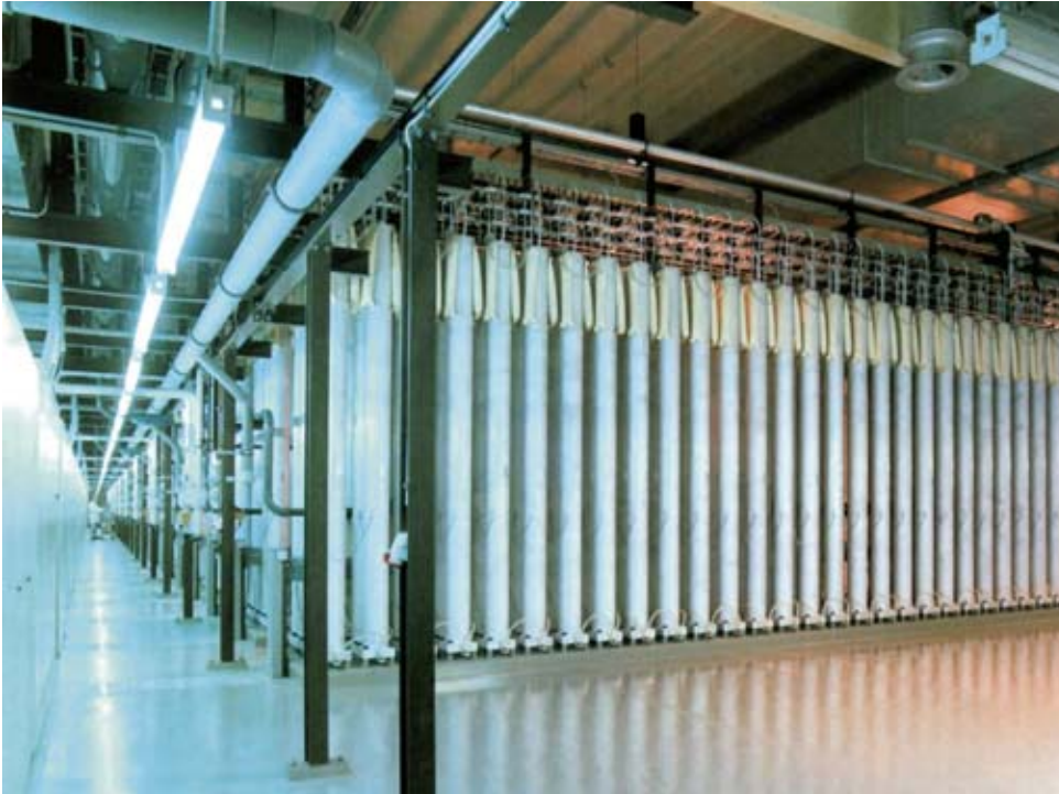
Kuva 5A-3 Isotooppiväkevöinnissä käytettäviä sentrifugeja.
