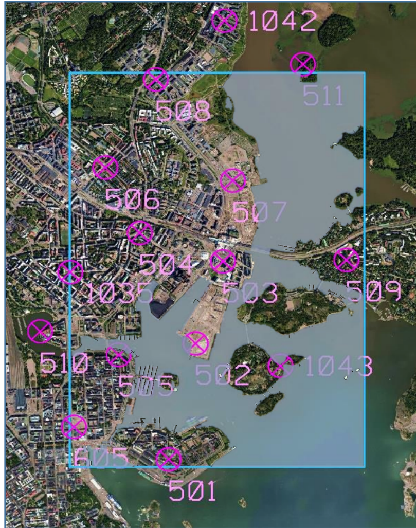
Kuva 6 Kalasataman testialueen 15 tukipistettä ja digitoitu vesialue.
