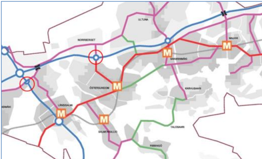
Vaihtoehtotarkastelussa poistetut eritasoliittymät.
