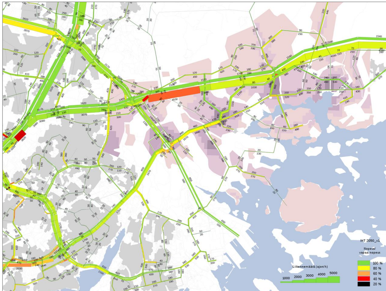
Tiiliikenteen kuormitus- ja sujuvuusennuste, iltahuipputunti
