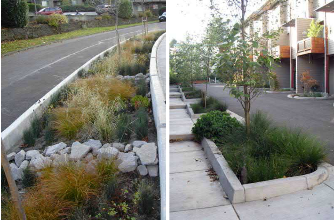
Kuva 6. Esimerkkejä katualueen viherkaistalle sijoitettavasta suodatuspainanteesta
