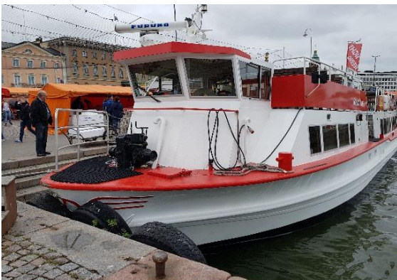
Kolera-altaassa useat veneet ajetaan paikalleen ajamalla ensin keula kiinni laiturin pehmikkeisiin (kuvassa autonrenkaat) ja sitten puskemalla kääntäen perän kohti laituria. Alukset kiinnitetään köysin kyljestä. Kuva Ramboll 2018.
