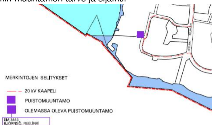
Kuva 5. Karhusaaren kaavarunko - sähköverkon 20kV yleissuunnitelmassa esitetty muuntamo (Etelä-Suomen Energia Oy, KSV).
