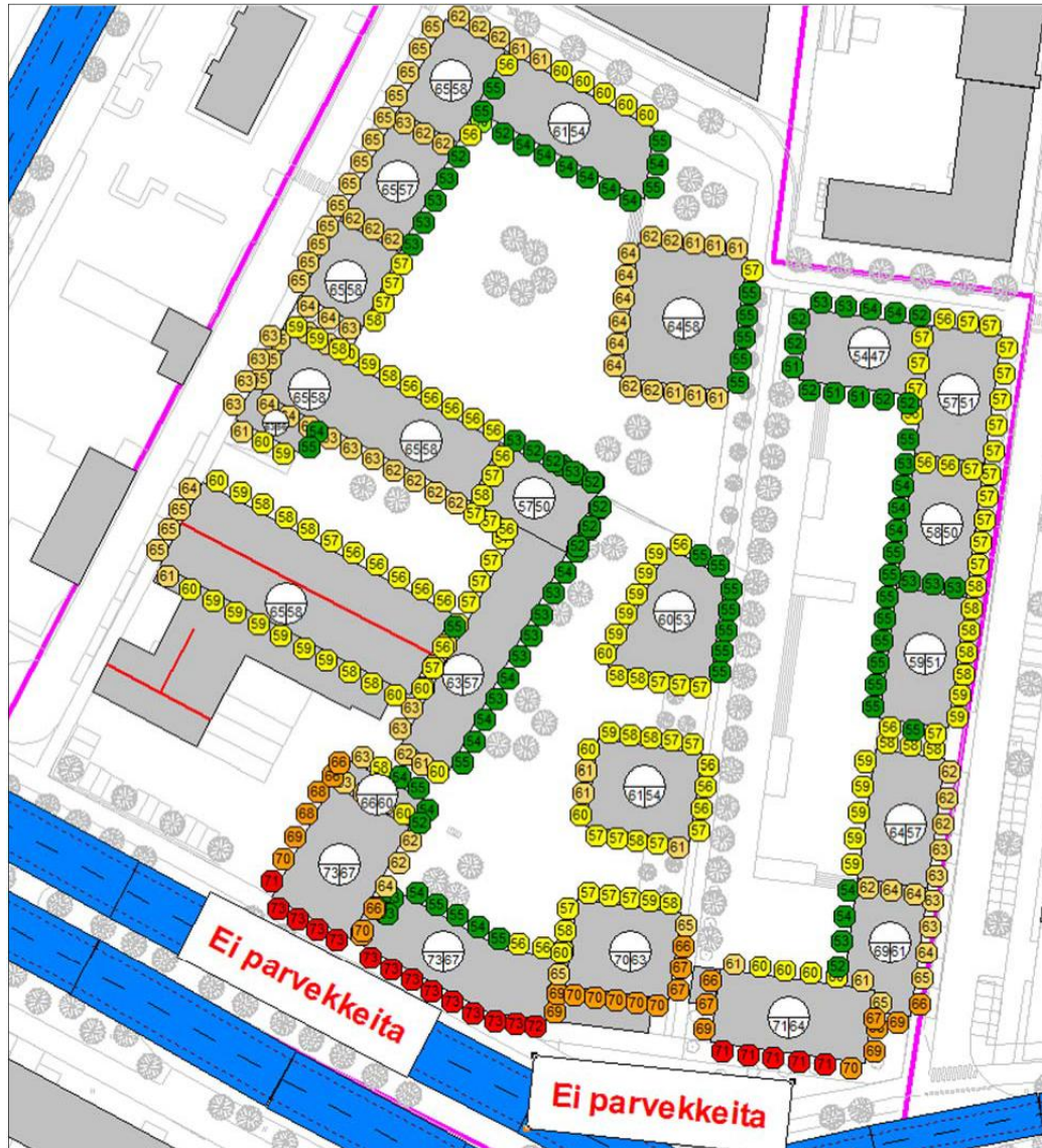
Kuva 3 Suurimmat suojaamattoman avoimen parvekkeen päiväajan melutasot
