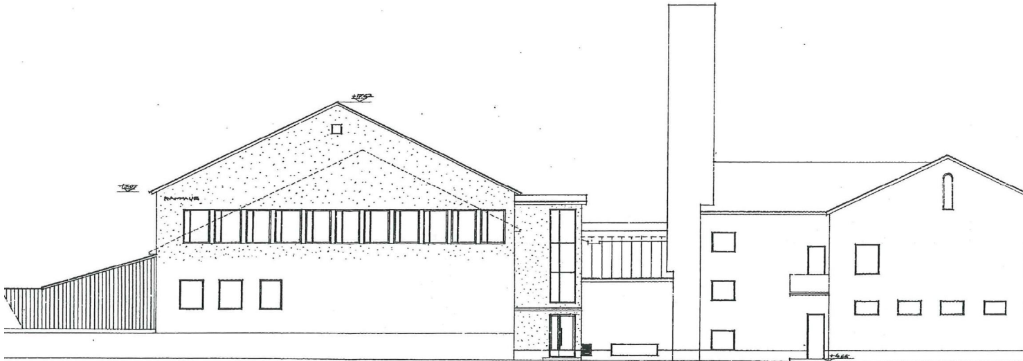
Länsijulkisivu korotuksen jälkeen. Huomaa nauhaikkuna ja uusi porrashuone. Myös länsipäädyssä alkuperäinen kaari-ikkuna ullakolle korvattu pienellä ikkunalla. Pauli Lehtinen 1965. Kuvalähde: Rakennusvalvonnan arkisto.
