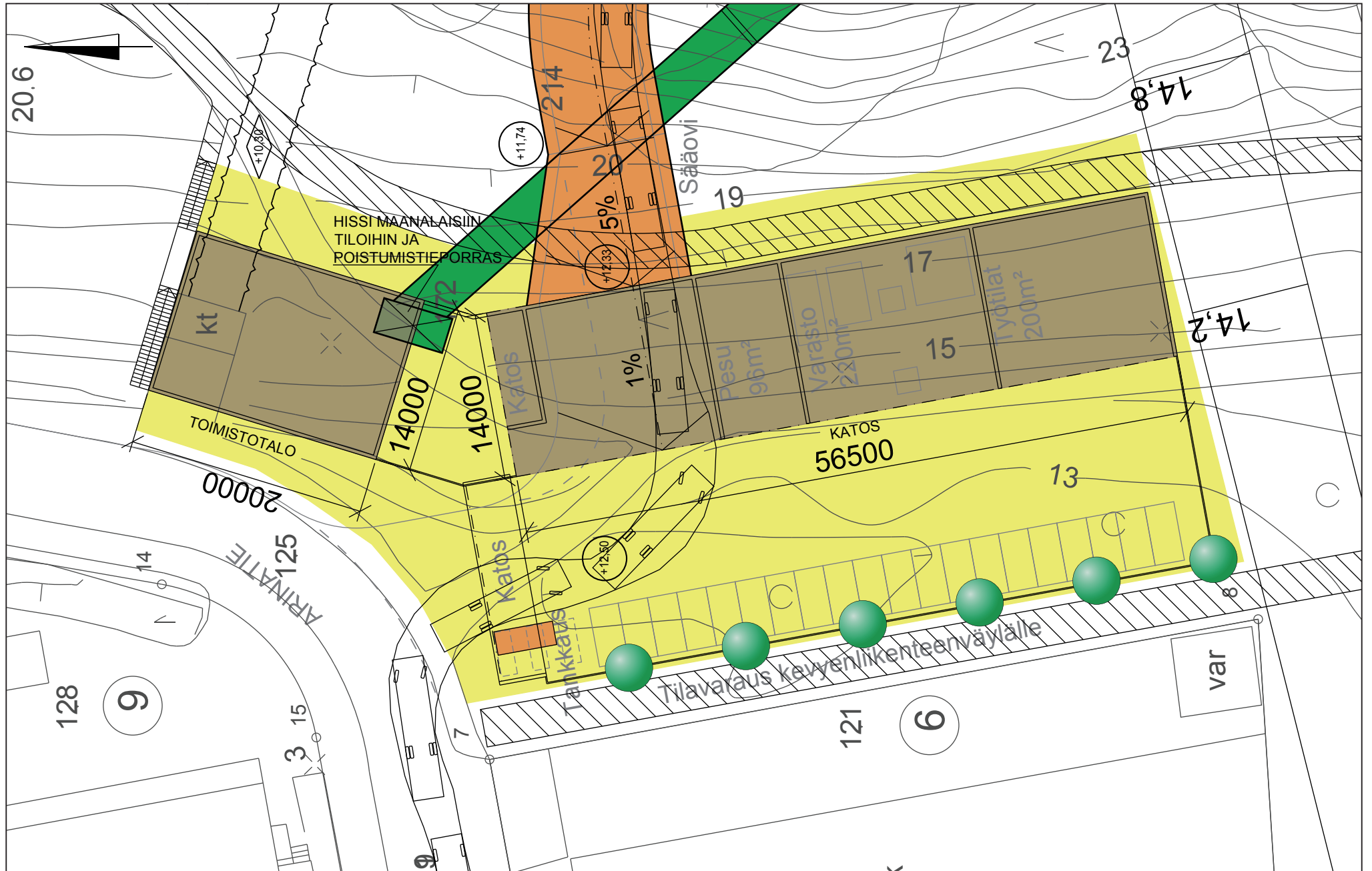
Kuva 20. Työtukikohdan maanpäällisten osien suunnitelma
