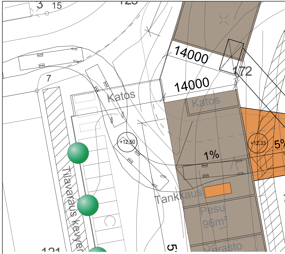
Kuva 29. Tankkausasema katoksen alla (ei täytä läpituulettavuusmääräystä)
