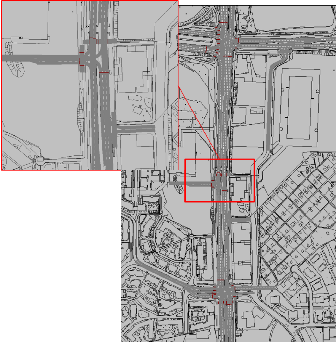
Kuva 12. Vaihtoehto 2, toimivuustarkasteluissa tarkasteltu täysi liittymä
