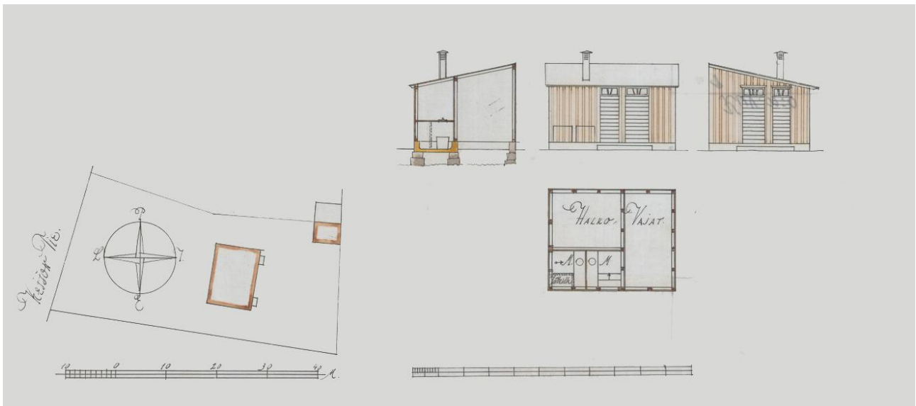
Tyypillisen, pulpettikattoisen piharakennuksen piirustus ja tontin asemapiirros, Hilding Ekelund. HKA
