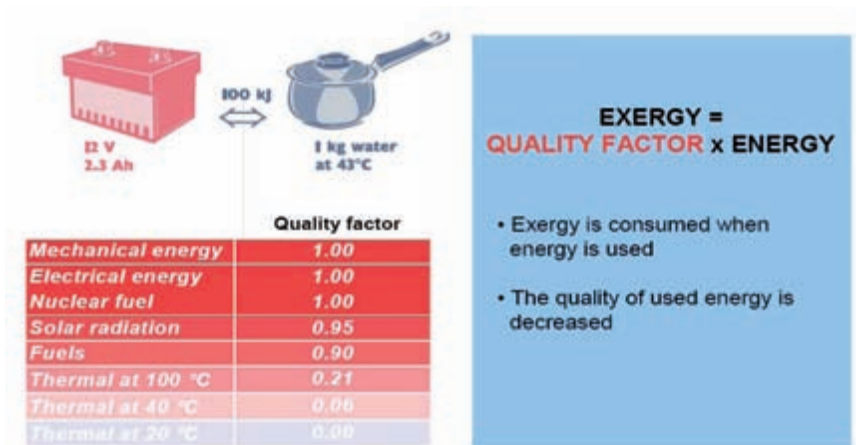
Kuva 15. Exergia on laatuenergiaa (IEA/ECBCS/Annex 38)
