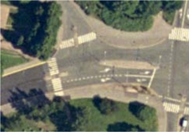
Kuva 32. Lasten koulureitille Isokaaren ja Myllykalliontien liittymään muotoiltu keskisaareke, joka on estää suojatien eteen pysähtyneen ajoneuvon ohittamisen (kuvat: 2008 ja 2010/ KMO/ ilmakuvat).
