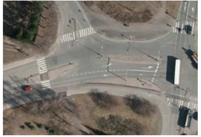
Kuva 32. Lasten koulureitille Isokaaren ja Myllykalliontien liittymään muotoiltu keskisaareke, joka on estää suojatien eteen pysähtyneen ajoneuvon ohittamisen (kuvat: 2008 ja 2010/ KMO/ ilmakuvat).
