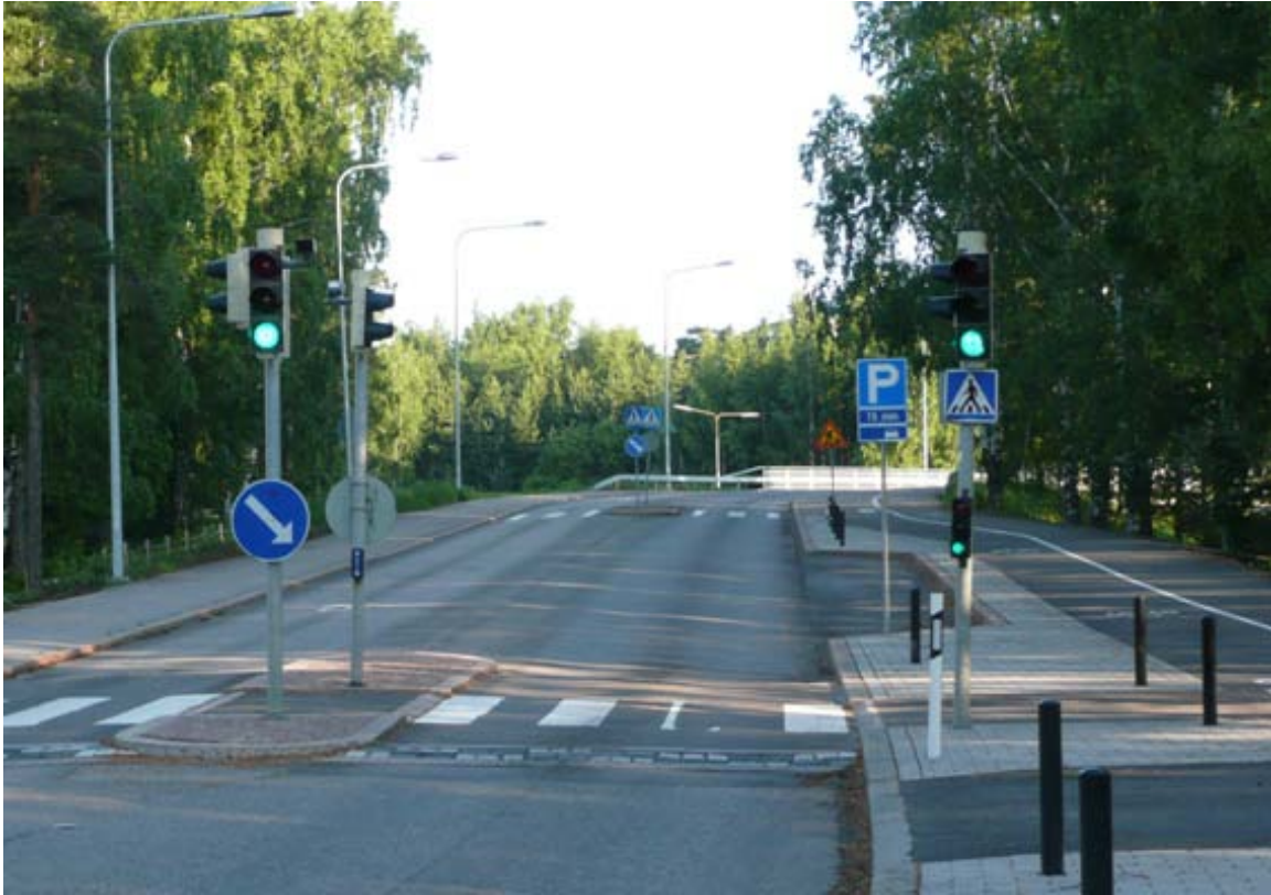
Kuva 39. Koulun saattopysäköintipaikka Professorintiellä (P 15 min). Kohteessa on myös kadunylityksen turvaamista varten tehty korotettu suojatie ja liikennevalot.
