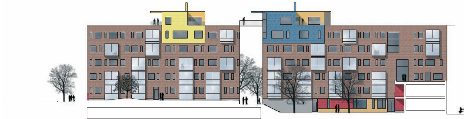
Julkisivujen ilmeisyys saavutetaan värillisillä metallipinnoilla, parvekkeiden ja ikkunoiden vaihtelevalla sijoittelulla.
