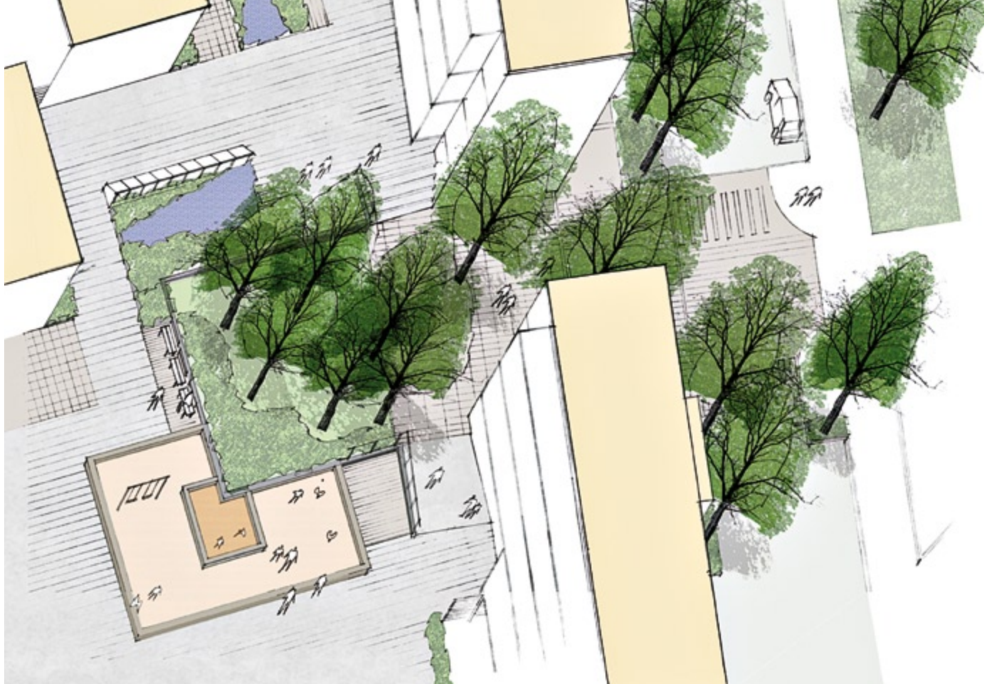
Aksonometria torialueelta. Rakennusten alakerrosten liiketilat avautuvat torialueelle. Torialue liittyy korttelipihaan luiskien ja maanvaraisen istutusalueen välityksellä.
