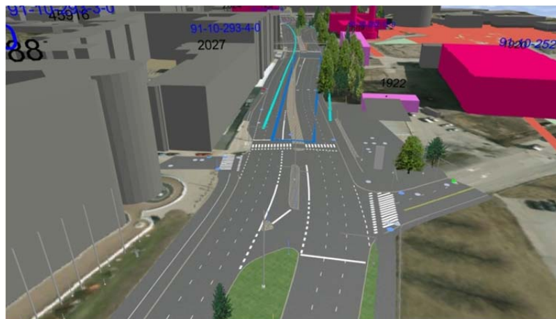
Kuva 9. Yhdistelmämalli mallinnetusta tiedosta sekä mm. 3D-rakennukset ja ilmakehän kuva-aineistosta
