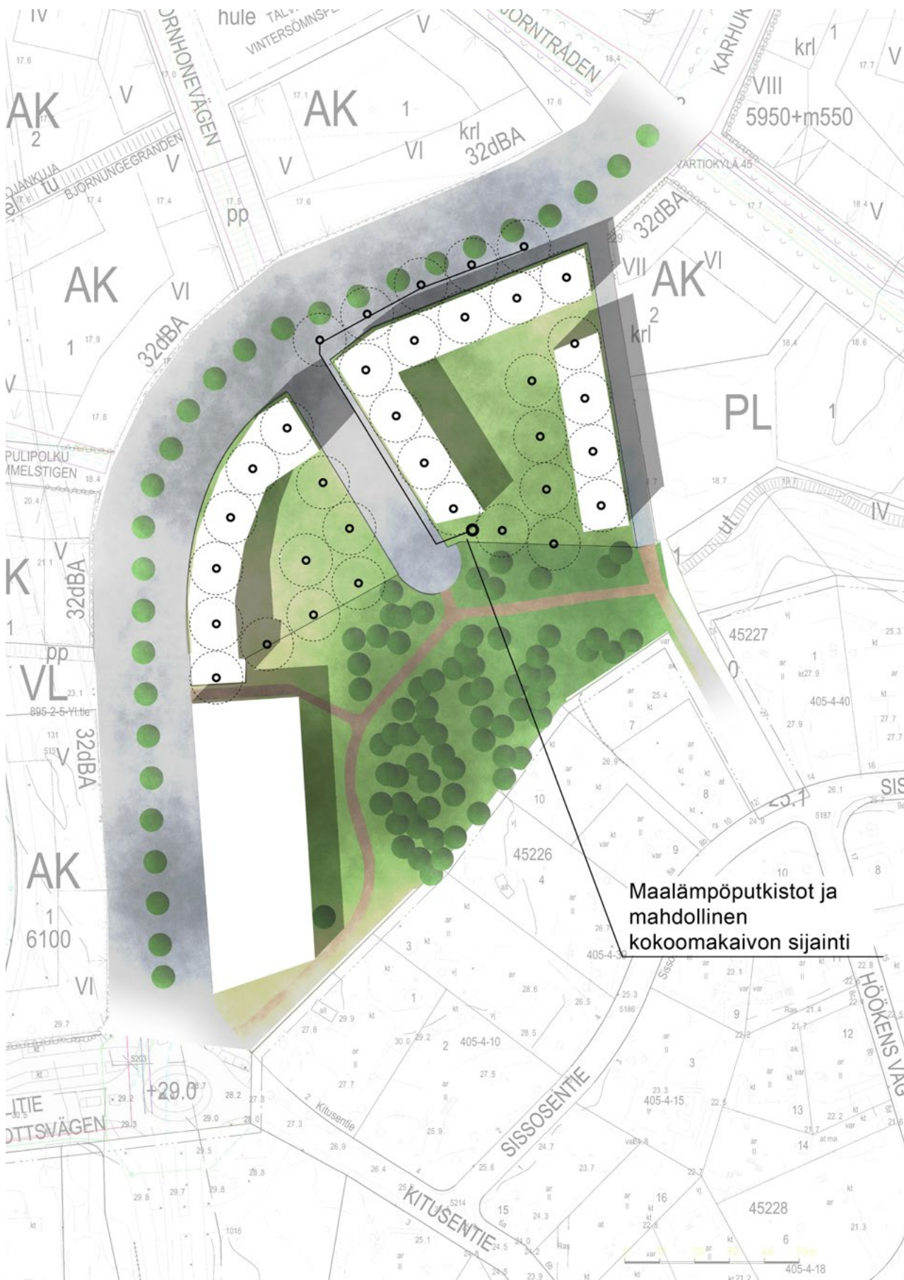
Kuva 19. Maalämpöpärjestelmän osien sijoittaminen katualueelle
