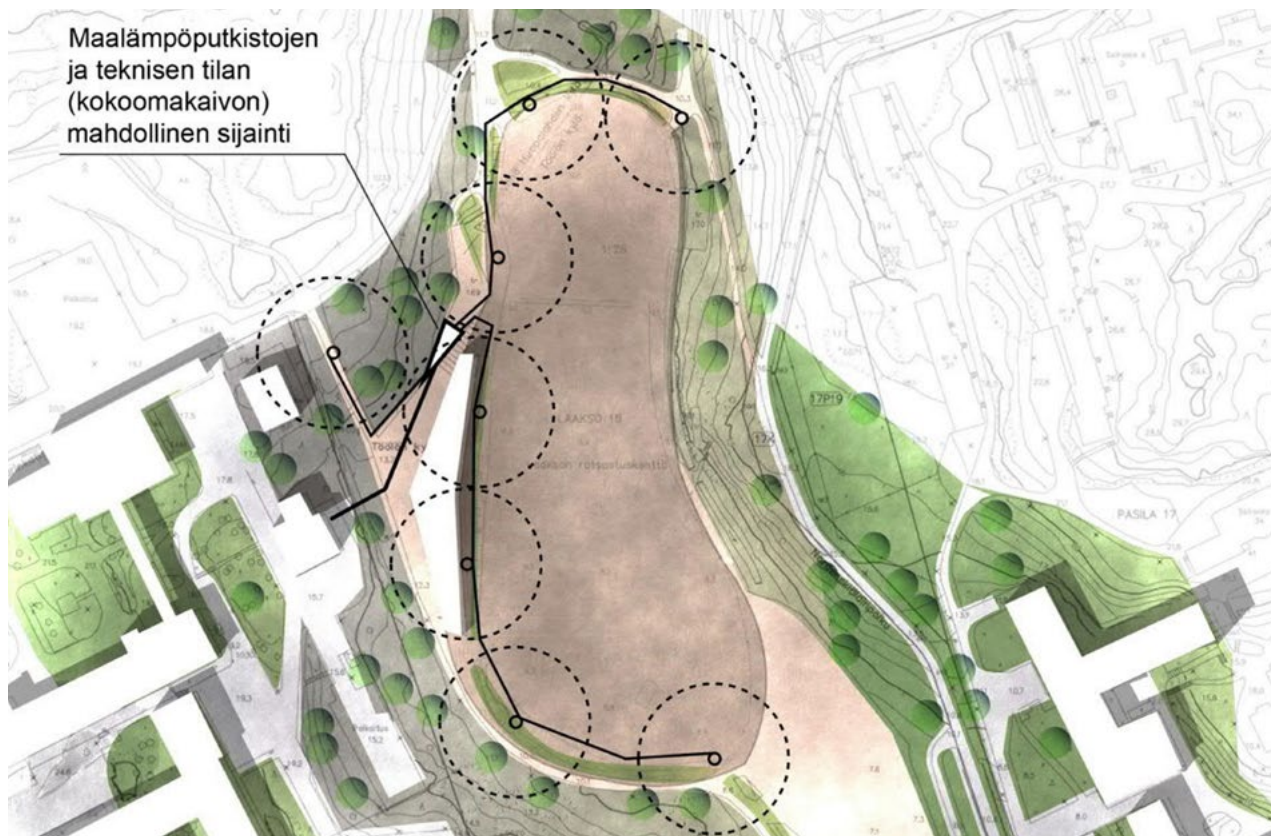
Kuva 26. Energiakaivojärjestelmän osien sijoittamislunnos
