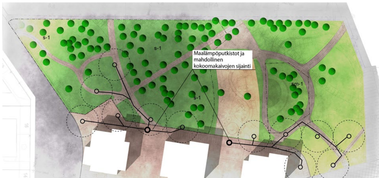
Kuva 22. Maalämpöjärjestelmän osien sijoittuminen rakennettuun puistoon.
