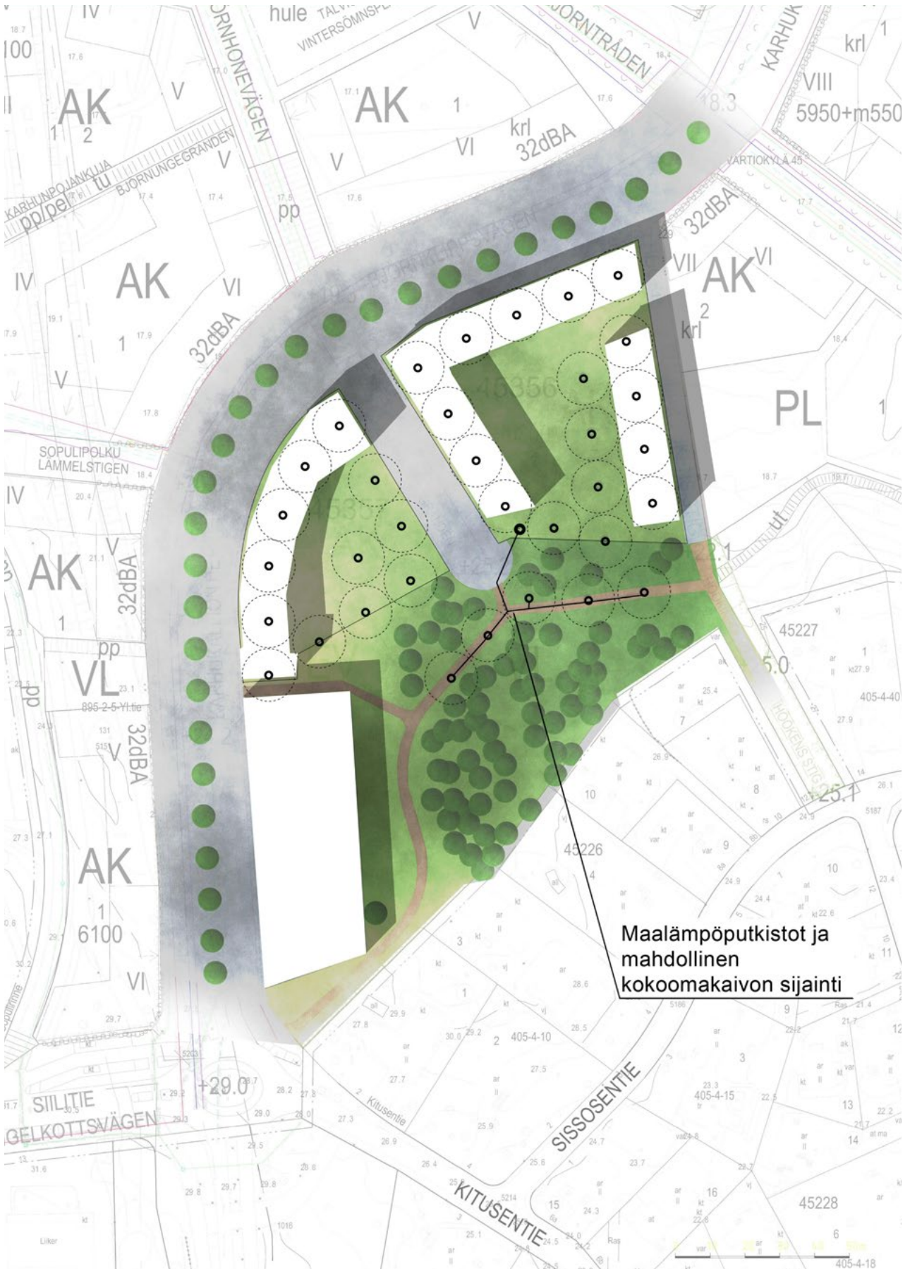
Kuva 16. Maalämpöjärjestelmän osien sijoittaminen viheralueelle.
