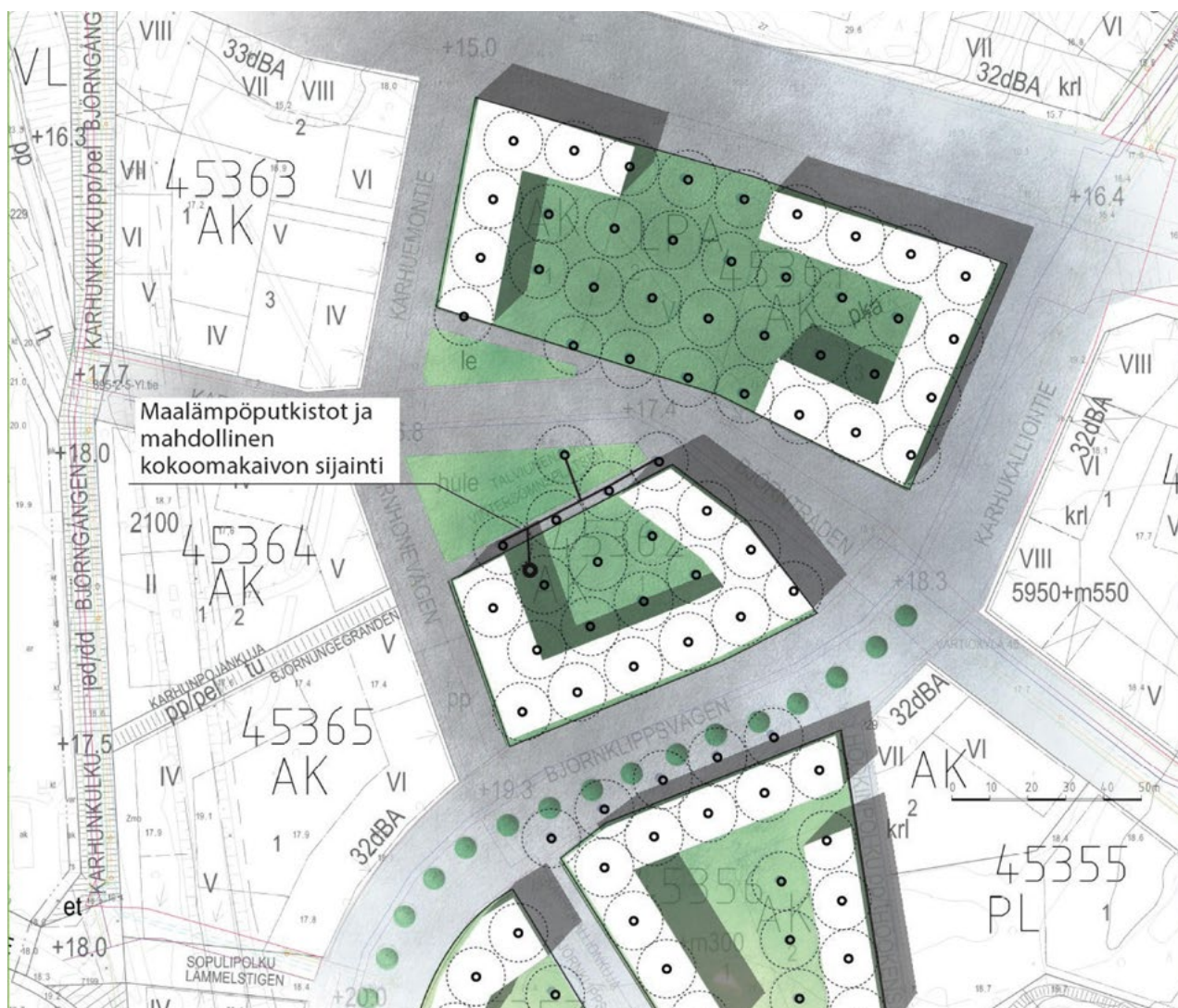
Kuva 24. Maalämpöjärjestelmän osien sijoittuminen LPA-korttelialueelle ja aukiolle. Kokoomakaivo on esitetty vain yleisiltä alueilta tuleville kaivoille.
